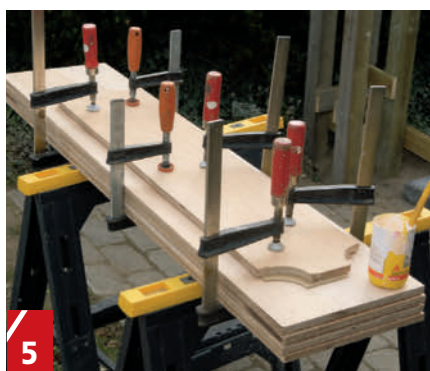
5 Smør lim på baksiden av trefiberplatene , og lim dem på frontplatene (C). Spenn sammen alle platene med skrutvinger til limet er tørt.
