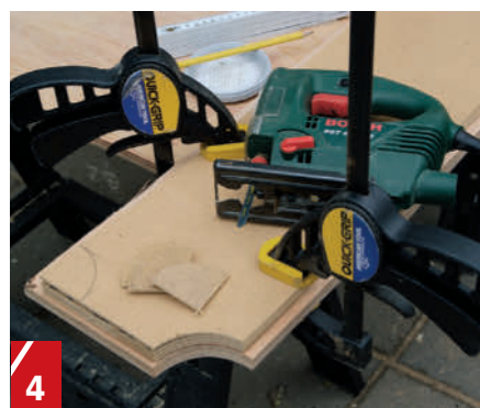
4 Tegn opp hjørnene på en av relieffplatene etter en rund gjenstand. Spenn platene sammen, og sag ut rundingene på begge platene samtidig.
