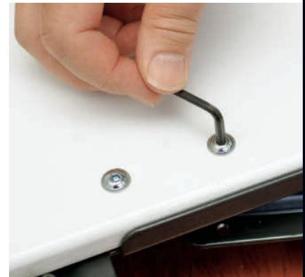
**5 Stram alle skruene** med en unbrakonøkkel. Bruk ikke så mye makt at skruenhodene graver seg ned i plata.
