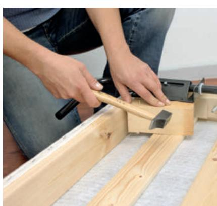
**6 Gi sengebeinbeslaget ekstra støtte** med en liten kloss. En del av beslaget henger fritt og må derfor understøttes. Sag nøyaktig til klossen og bank den inn under beslaget.
