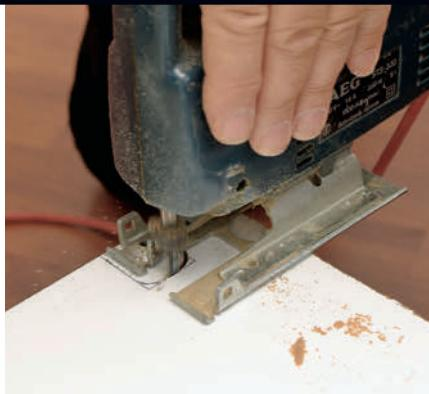
**2** Sag etter markeringen med ei stikksag slik at det blir et lite hakk som beinet kan stikke ut gjennom.
