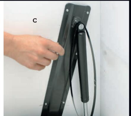
**3** Vipp senga slik at gasstøtdemperen kan skyves inn på plass på beslaget som er skrudd på skapsiden (C). Løft senga litt opp slik at stålbåndet slakkes. Fjern stålbåndet. Nå kan senga fritt beveges opp og ned i skapet.
