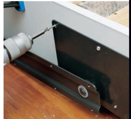
**6** Nå kan du også sette skruer gjennom de tre hullene i dreiebeslagene på forsiden. Bruk lange skruer som når godt inn i ramma på madrassen.
