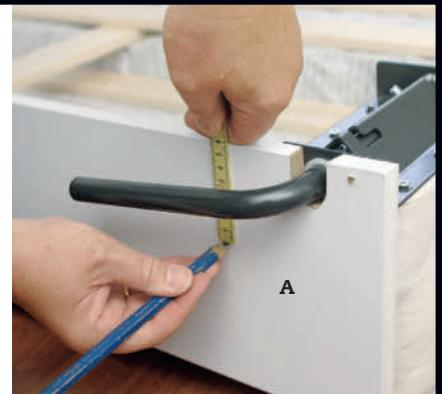
**3** Skru fast mdf-plata med universalskruer 5,0 x 25 mm i hver av de to uttrekkbare beslagene. Mål 8 cm ned fra underkanten av madrassen slik at du kan skru fast mdf-plata i bunnramma.
