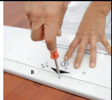
**2 Legg malen** som følger med beslagene på en utvendig langside, og merk opp hull til skruene. Her er den lagt opp til 7 mm hull.
