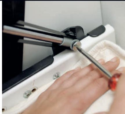
**2** Sett skruen som følger med i gasstøtdemperen. Stram skruen godt slik at demperen ikke kan komme på avveier når stålbåndet løsnes om litt.
