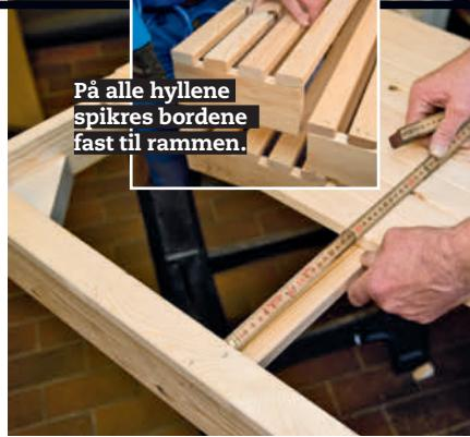
**2 Mål opp til avstanden mellom de 11 bordene på bunnhyllen.** Sett de to ytterste bordene fast, og legg deretter i de øvrige. Mål det overskytende stykket, og del det på 10, så har du den avstanden som skal være mellom bordene.
