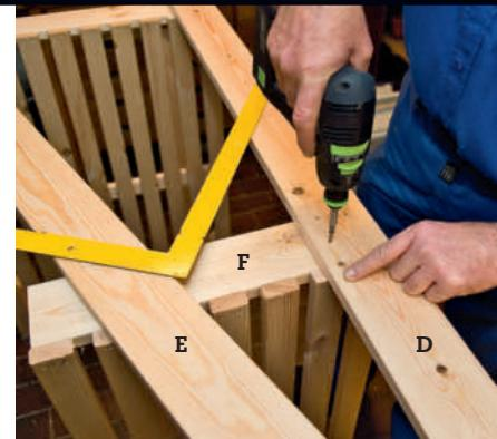
**3** Skru fast den midterste hyllen. Bruk 5 x 40 mm skruer. Hyllen plasserer vi 85 cm fra bunnen, slik at det er plass til store planter på nederste hylle. Skruene skaper en mer stabil konstruksjon enn spikerne kan klare.
