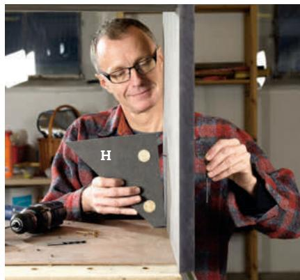
**3 Sidene (B) og den smale vangen (D) monteres** på samme måte med plagger og monteringsskruer. Den smale vangen skal plasseres akkurat midt på sidene. **TIPS:** Med et stort, rett bord kan du flytte arbeidet opp i en behagelig arbeidshøyde.
