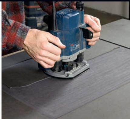
**2** **Fres vekk resten av materialet innenfor kantene.** Begynn fra en ende, og arbeid deg rolig bort over flata. **TIPS:** Arbeider du innendørs, kan du minsk støvplagene ved å sette en støvsuger opp til overfresen.
