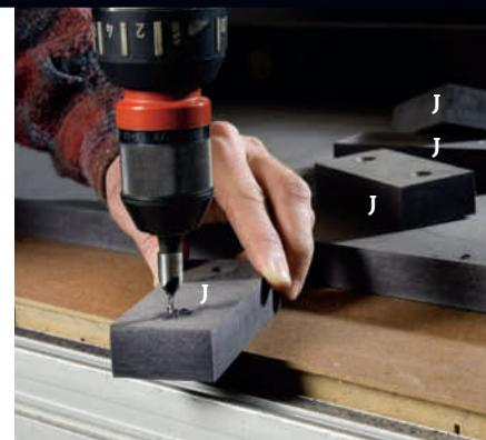
**1 Bor opp i de fire styreklossene (J)** – to 4 mm hull i hver. Legg bordplata med baksiden opp, og sett understellet opp ned oppå bordplata. Tilpass delene slik at plata ligger der den skal.
