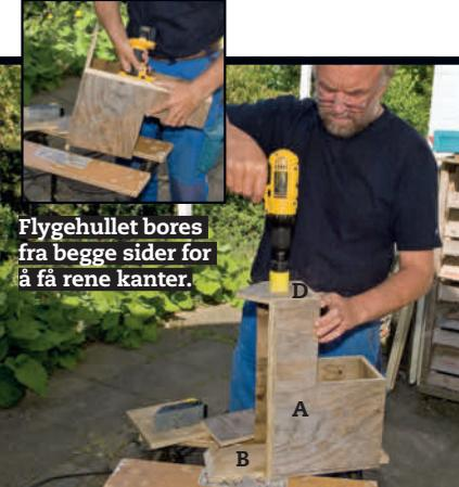
**2 Delene monteres.** Det letteste og raskeste er å montere dem med en spikerpistol, men har du ikke det, bruker du bare spiker eller skruer. Et 45 mm hull passer til halvstore fugler, f.eks. stær.
