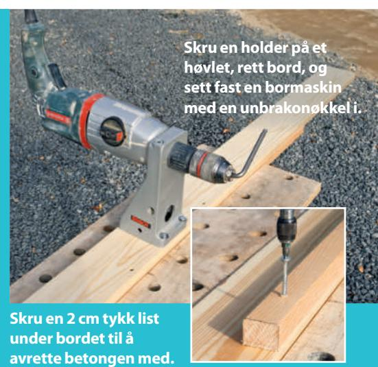
**Skru en holder på et høvet, rett bord, og sett fast en bormaskin med en unbrakonøkkel i.**
