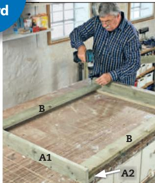
**1** Hvert bein er laget av ett bord på 25 x 100 mm (A1) og ett på 25 x 75 mm (A2). De er satt sammen i vinkel. I flukt med toppen og 2 cm over bakken festes to lossholter (B) innvendig på beina.
