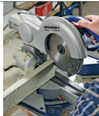
**2** Bruk en stoppkloss på kapp-/gjærsagen, når bordene skal tilpasses i lengden. Kapp bordene til hjørnestolpene med et par centimeter overmål, slik at det er plass til en helling i toppen.
