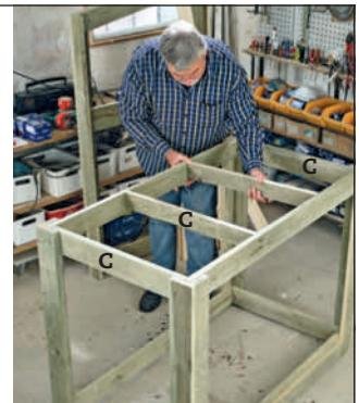
**3** Sidene forbines med toppbordene (C), som festes innvendig i beinas vinkel med 5 x 45 mm skruer. To ekstra bord (C) monteres. De skal gi ekstra støtte til taket. Bordet (E) monteres.
