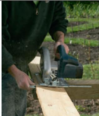
**1 Sag til et bord på langs** til hjørnene på benken. Del det slik at du får to stykker på ca 6 og 9 cm bredde. Etterpå kappes de på 65 cm i lengden.
