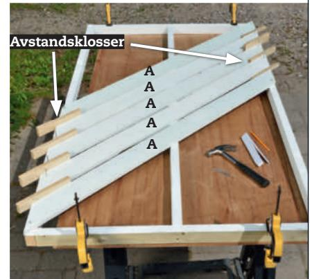
**3 Skjær ut alle bordene** med en kapp-/gjærsag. Vinkelen skal være 45°, og snittene skal være parallelle. Det kan være en god idé å lage et sett bord som du kan streke alle de øvrige etter.
