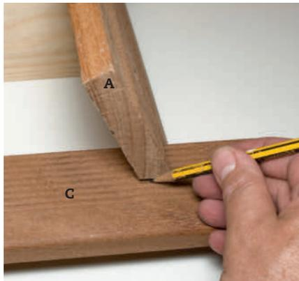
**4 Sett tverrstiveren (C) inn i hakket,** og tegn opp der du skal sage et tilsvarende hakk i det. Strek opp rundt hele og på begge sider, slik at du har en markering å sage det skrå hakket etter. Hakket skal være 6 cm fra enden.
