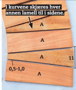
**1 Lamellene (A) skjæres ut og spisses til.** Først skjærer du dem ut i 40 cm lange stykker. Legg dem på bakken med luft mellom. I de skarpe kurvene i to lag. Strek opp der hver annen skal spisses til, og skjær dem til.
