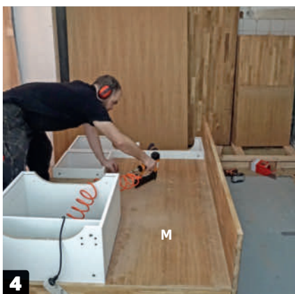
4 Søm nu bagpladerne fast med enten en sømpistol eller en stifthammer – vær meget omhyggelig med at sætte søm/stifter lige midt i pladerne.
