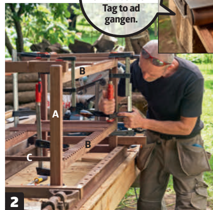
2 Bordet sættes i spænd. Der limes et par tremmer (C) fast i hver ende af bordet i top og bund. Det sikrer, at afstanden er helt rigtig, og holder bordet på plads.
