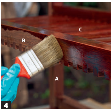
4 Bordet behandles med linolie. Eventuelle limrester slibes væk. Farveskiftet taler virkelig for sig selv!
