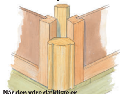
Listen til ydersiden passer om tagspæret. Den skrues fast fra indersiden i beslagene.
