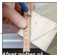
Afsæt midten på endekanten. Lav to skrå streger som vist, fra hjørnet og ud til midten.
