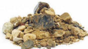
Stabilgruset danner en formstabil bund.
