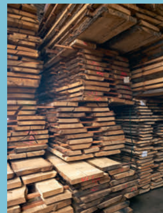
Træet tørrer i en stor hal på paller med lister imellem skrivelserne.
