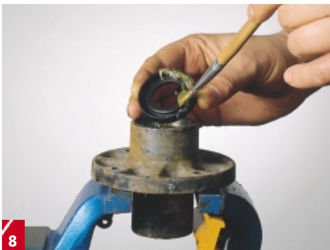
8 Lägga på lite fett på packboxens invändiga sida (det är lättast med pensel) och pressa ner packboxen i navet. Om det är svårt att få den på plats så kan du kancka lätt på den med hammare och slagkloss.
