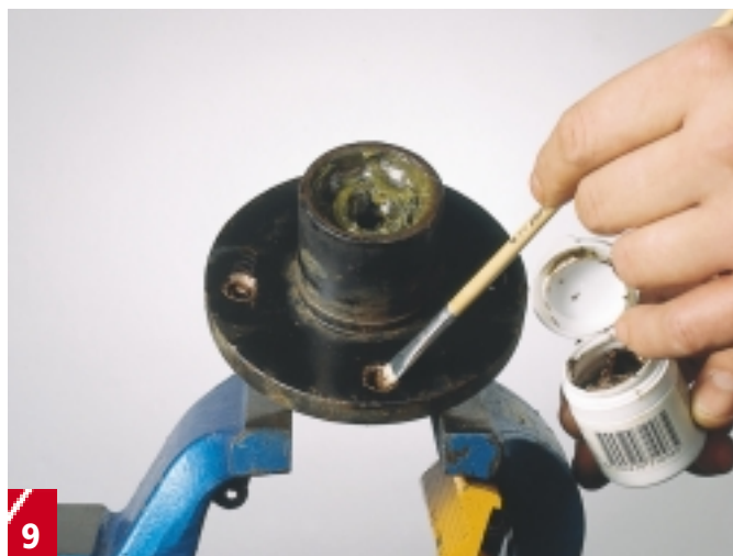
9 Nu när du ändå har plockat isär navet bör du passa på att smörja gängorna till hjulbultarna med kopparfett. Pensla rikligt och torka bort överflödigt fett. Då blir det lättare att lossa hjulbultarna nästa gång.
