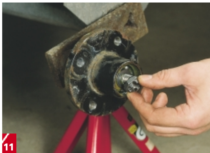
11 Skjut in brickan över spindeln och dra åt muttern med passande nyckel. Lossa muttern lite grann så att du kan trycka in sprinten i den första skåran i muttern. Lås sprinten genom att vrida ut ett av benen.
