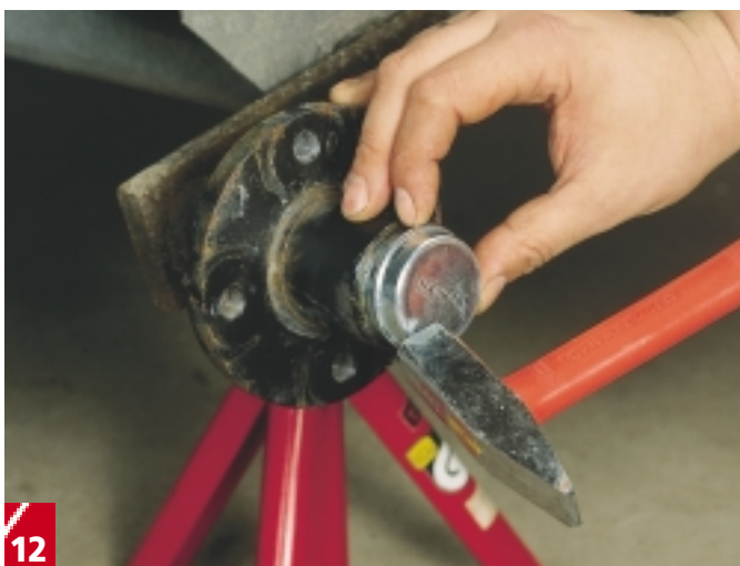
12 Knacka fast navkapseln med hammare. Gör det försiktigt eller använd slagkloss. Montera hjulet och hjulbultarna som dras åt först när alla sitter i. Börja med nr 1, fortsätt med nr 3, nummer 2 och nummer 4.
