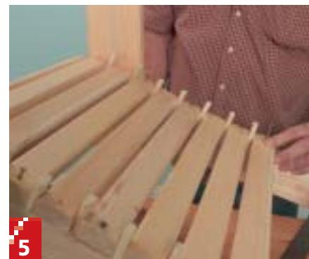
**Setelistene (C) festes med skruer (4 x 50 millimeter) ned i kanten av vangen (A). Forbor og forsenk. Bruk 9 millimeter avstandsklosser mellom listene.**
