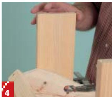
**De fremste beina (B) sitter utvendig på vangen (A) og festes med lim og fire forsenkede skruer (4 x 40 millimeter) innenfra gjennom vangen.**
