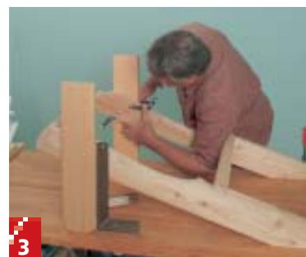
**Vangene (A) spennes midlertidig fast ned mot arbeidsbordet. Mål 9 cm inn fra framkanten av vangen til framkanten av beinet (B). Når beina står vinkelrett på arbeidsbordet, er det 22 centimeter til underkanten av vangen. Beina festes midlertidig med tvinger.**
