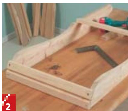
**Fest et par setelister (C) i fronten og ei midlertidig i hakket til ryggenet i vangene (A). Legg merke til at setelistene i fronten festes med 2 millimeters avstand i bunnen. Det er også viktig at du passer på konstruksjonen er i vinkel.**
