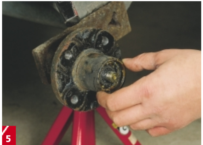
5 Trekk navet av akslingen, og fjern pakningsringen på baksiden med en skrutrekker. Slå lagrene ut med hammer og dor, og rens navet for fett. Det kan inneholde urenheter som kan ødelegge de nye lagrene.
