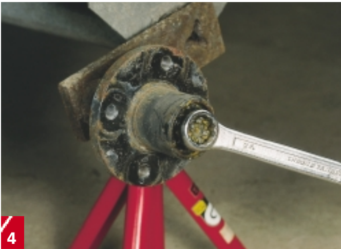
4 Løs mutteren med en fastnøkkel i riktig størrelse (vanligvis 24 mm), fjern mutteren og låseskiven (sprengskiven) som ligger bak. Skiven fjernes enklest ved å vippe den ut med en liten skrutrekker.
