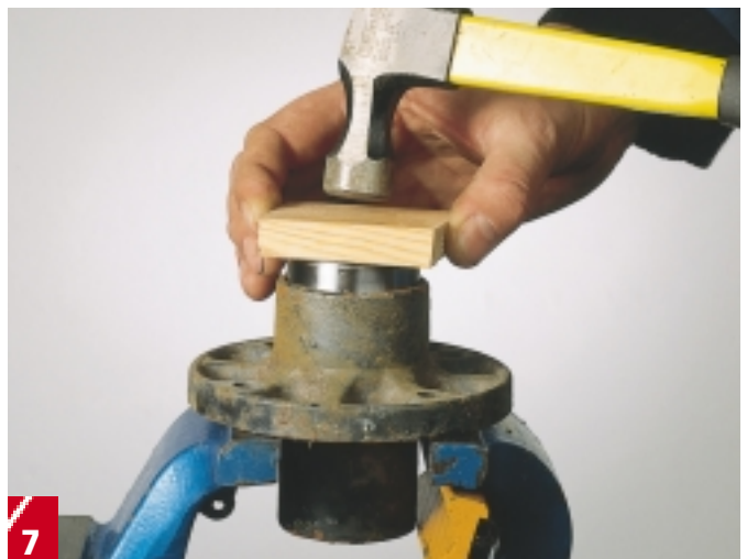
7 Sett navet fast i en skruestikke, og slå lageret forsiktig ned med en hammer og en kloss. Pass på at lageret ligger plant. Slå lageret på plass med hammer og dor. Slå forsiktig på lagerets ytterkant, aldri på de innvendige delene.
