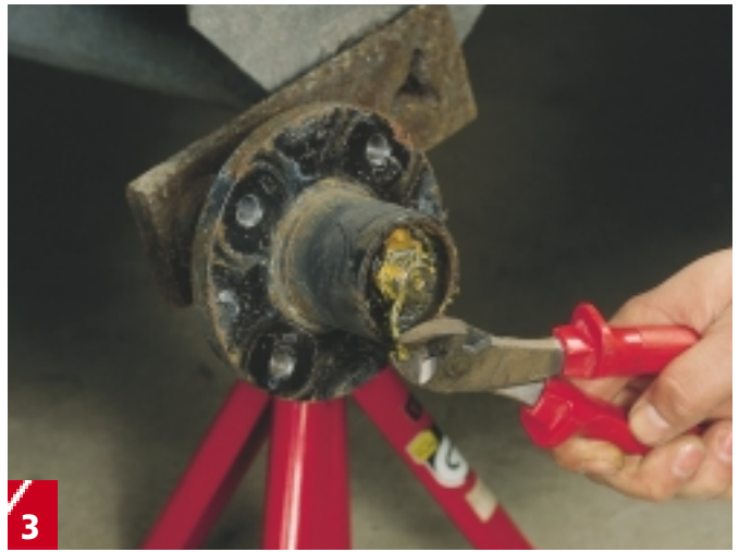
3 Er navet fylt med fett, tørkes dette vekk med en klut slik at mutteren blir ren, og du kan se splinten i navet. Splinten låser navmutteren og fjernes lett med en tang.
