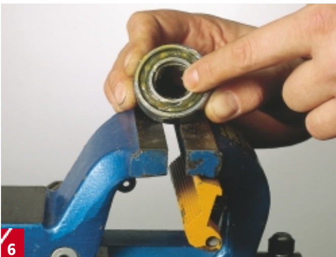
6 Smør sidene i de nye lagrene med lagerfett, og dreii den innerste delen av lageret rundt til du kan se at fett har fordelt seg, og lageret går lett. Etterfyll sidene på lageret med fett igjen før det monteres.
