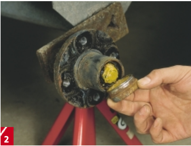
2 Fjern navkapselen. Hold en skrutrekker mot kapselens kant og slå den forsiktig ut med en hammer. Slå en gang med hammeren, dreii navet, og slå igjen. Etter et par slag går kapselen av.
