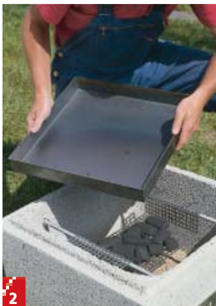
2 Bakken til røgesmuldet laves af en 50 x 50 cm jernplade. I hvert hjørne skæres et felt på 5 x 5 cm ud, og flapperne bukket op til sider. Lad en smed klare den sag – pladen er 3 mm tyk.
