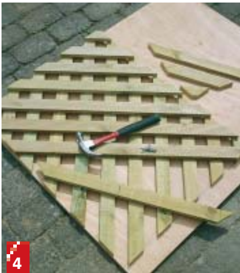
4 Tegn omridset af espalieret på en træplade og læg listerne med en hældning på 45 grader ud. Start med den midterste liste (N 1 ) og fordel resten herfra. Søm øverste lag lister på med 18/35 søm.
